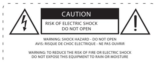
L'éclair dans un triangle alerte l'utilisateur d'une tension dangereuse non isolée dans l'appareil. Risque d'électrocution pour les personnes.
